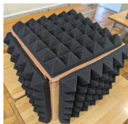
図 5-3 吸音スポンジ
