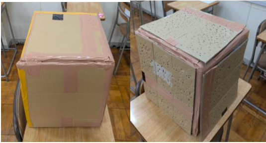
図 6-2 実験④の様子 左:厚さを 1 cm にした段ボール 右:厚さ 1cm で表面に穴を開けた段ボール
